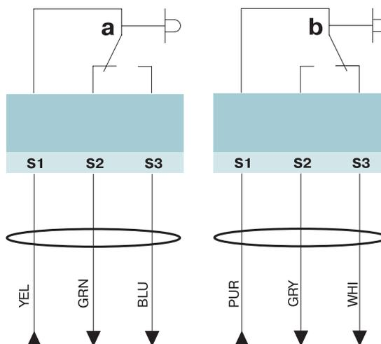
Положение *a* переключателя соответствует углу 5°, положение *b* – углу 85°
